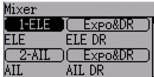
Микшер Deviation смоделирован с прошивки E9x. Каждый выходной канал состоит из серии одного или нескольких микшеров, каждый из которых содержит один вход, переключатель активации и функцию/кривую, которая модифицирует выход микшера. Это очень мощная возможность, но требует хорошего понимания для полного использования. Для упрощения применения, имеется 3 шаблона, которые были созданы для облегчения определения каналов.
