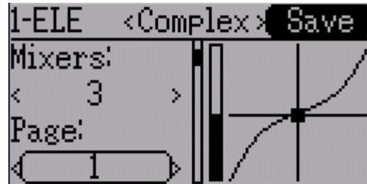
предыдущие микшеры для этого канала. С помощью этой системы возможно определить выходной канал, как комбинацию любого числа вводов.
