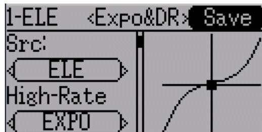
Выбор значения для 'Switch1' или 'Switch2' будет активировать соответствующий раздел. Каждый раздел может иметь привязанную (linked) кривую (кривая такая же как для 'High-Rate'), в таком случае можно изменять только масштаб, или раздел может иметь независимое определение кривой. Нажатие кнопки 'Mid-Rate' или 'Low-Rate' для данного переключателя будет переключать между привязанной и независимой кривой.
