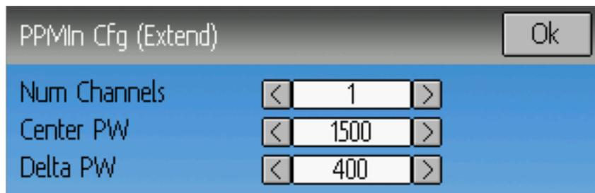
Deviation ermöglicht es, PPM Eingangssignale von einer externen Quelle zu nutzen (wie beispielsweise ein FPV Aufbau). Um diesen Modus zu konfigurieren, setzen Sie im Abschnitt *Modelleinstellungen [Model setup] (Standard & Advanced GUI)* den ‚PPM Eingang‘ [PPM In] auf ‚Erweitert‘ [,Extend‘].
