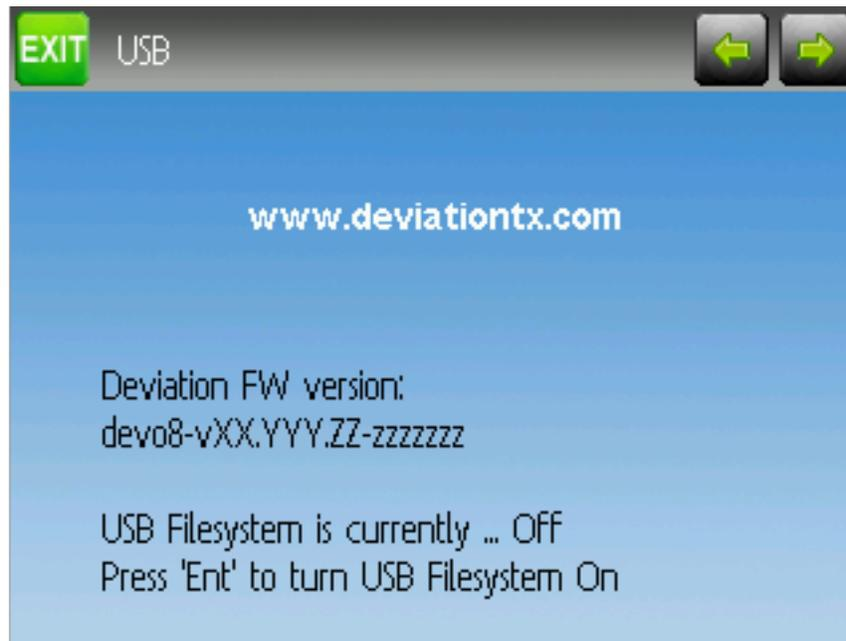
Die USB-Seite kann über die Auswahl von ‚USB‘ im Hauptmenü erreicht werden. Der USB-Modus kann ein- und ausgeschaltet werden und ermöglicht den Zugriff auf das Dateisystem des Senders über einen via USB angeschlossenen Computer. Ist der USB-Modus aktiviert, erhalten Sie Zugriff auf das Deviation Dateisystem als USB-Massenspeicher. Dort können Sie Dateien zwischen Computer und Sender bewegen oder kopieren. Alle Konfigurationsdateien sind in diesem Modus verfügbar.
