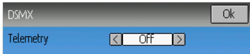
Das DSMX Protokoll unterstützt ebenfalls Aktivieren und Deaktivieren der Telemetriefähigkeit. Diese Option ist zugänglich durch Drücken des Protokoll Drehfelds wenn DSMX angezeigt wird.
