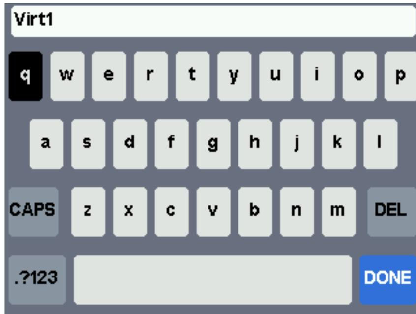
Wenn Sie ENT auf einen virtuellen Kanal drücken, erscheint ein Tastaturbildschirm, in dem Sie den vor-eingestellten Namen ändern können. Verwenden Sie die links, rechts, hoch und runter Knöpfe zur Auswahl eines Zeichens und drücken Sie dann ENT. Oder verwenden Sie den Touchscreen.
