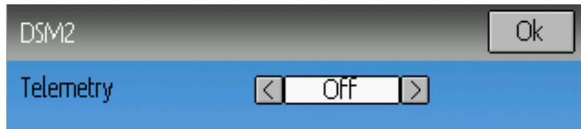
Das DSM2 Protokoll unterstützt ebenfalls Aktivieren und Deaktivieren der Telemetriefähigkeit. Diese Option ist zugänglich durch Drücken des Protokoll Drehfelds wenn DSM2 angezeigt wird.
