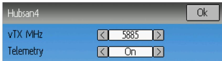
Das Hubsan4 Protokoll unterstützt bis zu 13 Kanäle und unterstützt im regular Format nur automatisches Binden. Eine feste ID kann verwendet werden, verhindert jedoch nicht die automatische Bindung beim Einschalten. Die ersten 4 Kanäle bilden Querruder, Höhenruder, Gas und Seitenruder ab. Zusätzliche Kanäle steuern die Spezialfunktionen des Quadrocopters:
